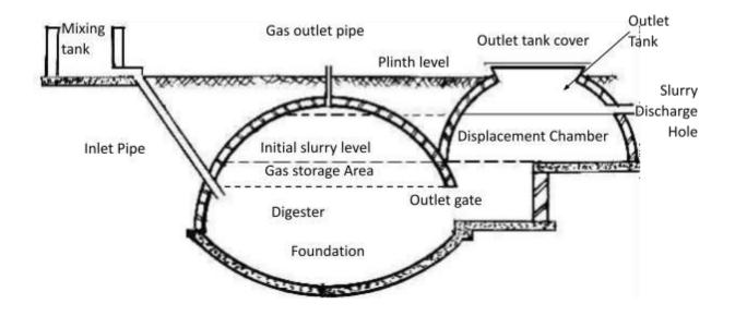
Fig.: Deenbandhu Biogas plant
